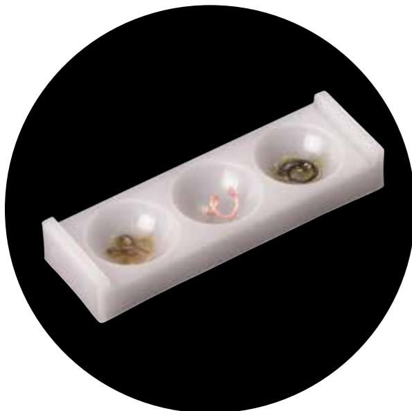
Dans la coupelle de gauche : Fil non imprégné immergé dans une solution de sulfate de fer (pas de coloration).
